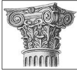
圖 5 羅馬把愛奧尼亞柱頭加在哥林多式茛苈葉柱頭上成為羅馬的複合式柱頭。
